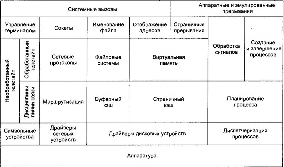
Рис. 10.2. Структура ядра операционной системы UNIX 4.4BSD
