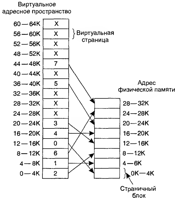
Рис. 4.10. Связь между виртуальными и физическими адресами, получаемая с помощью таблицы страниц
