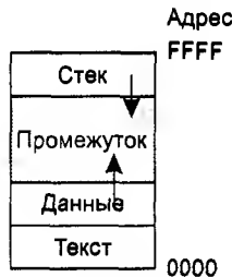
Рис. 1.18. Под процессы отводится три сегмента: текст, данные и стек
