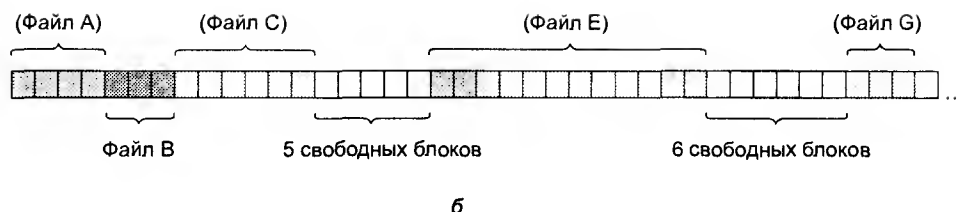
Рис. 6.9. Семь непрерывных файлов на диске (а); состояние диска после удаления двух файлов (б)
