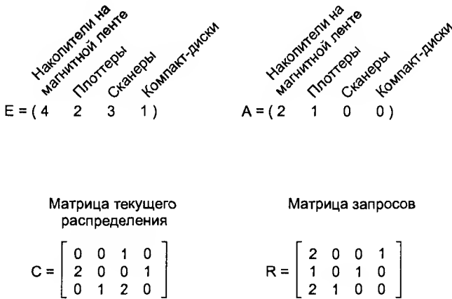
Рис. 3.5. Пример использования алгоритма обнаружения тупиков
