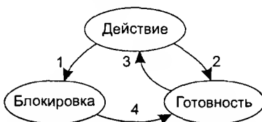
Рис. 2.2. Процесс может находиться в рабочем, готовом и заблокированном состоянии. Стрелками показаны возможные переходы между состояниями
