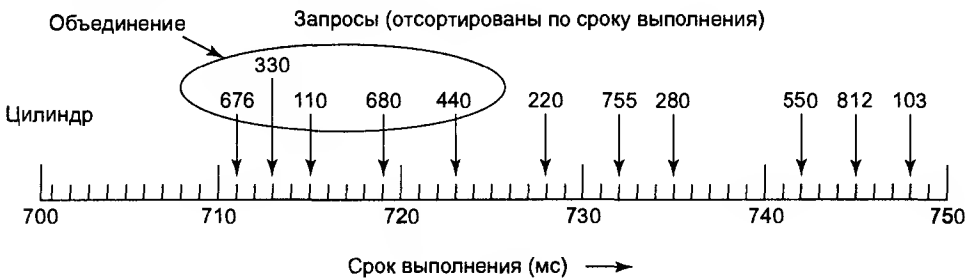
Рис. 7.24. Обработка пакетов при помощи алгоритма scan-EDF
