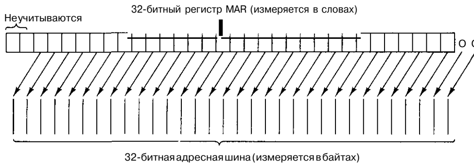
Рис. 4.3. Распределение битов регистра MAR в адресной шине
