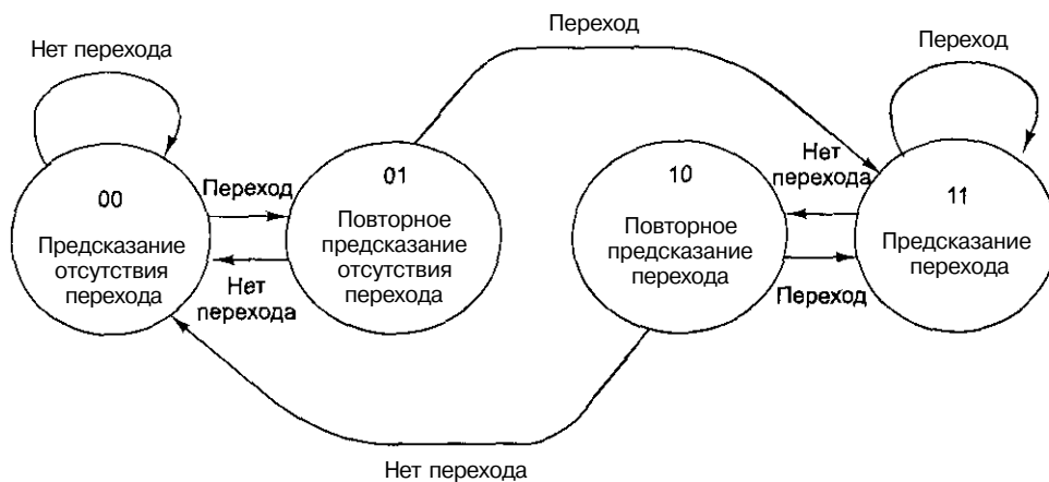
Рис. 4.29. Двубитный конечный автомат для прогнозирования переходов
