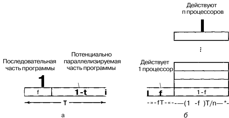
Рис. 8.9. Программа содержит последовательную часть и параллелизуемую часть (а); результат параллельной обработки части программы (б)
